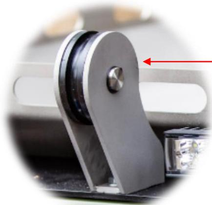
Die Umlenkrolle für die Seilwinde dient dazu, die Richtung des Seils zu ändern und die Zugkraft zu erhöhen oder zu verringern. Indem das Seil über die Umlenkrolle geführt wird, kann die Seilwinde das Gewicht oder die Last in verschiedene Richtungen ziehen oder heben. Die Umlenkrolle ermöglicht es, die Kraft effektiv zu verteilen und die Last gleichmäßig zu bewegen, was die Effizienz und Kontrolle der Seilwinde verbessert.
